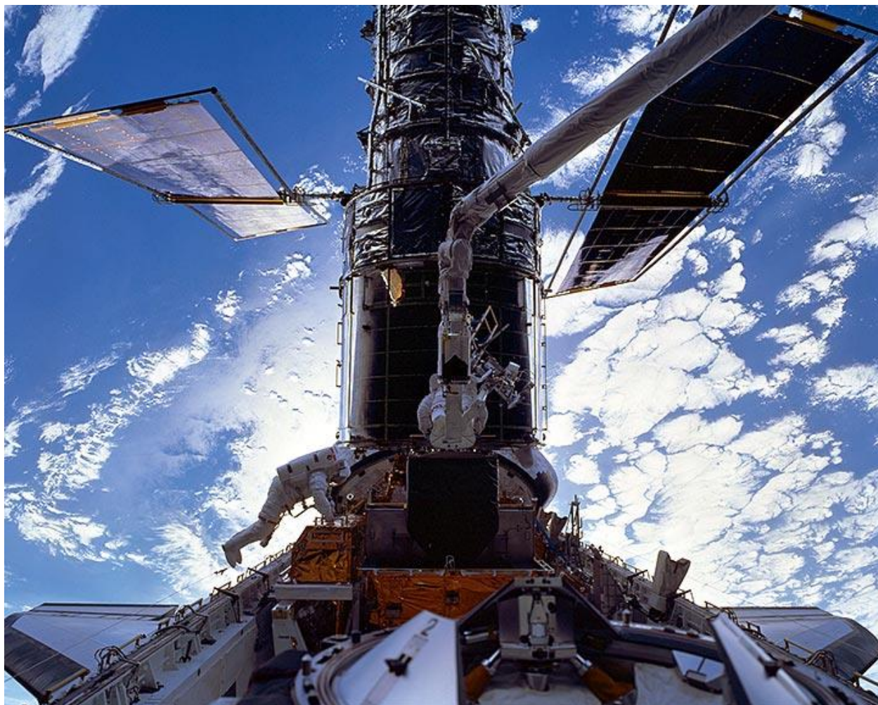
Слика 33: инсталација новог сензора за фино навођење у оквиру Сервисне мисије 3А
