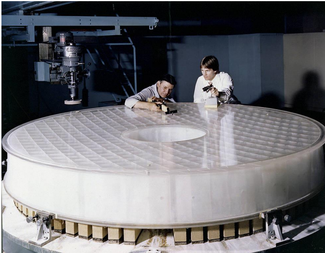
Слика 22: тестирање непремазаног примарног огледала пре лансирања 1990. године
