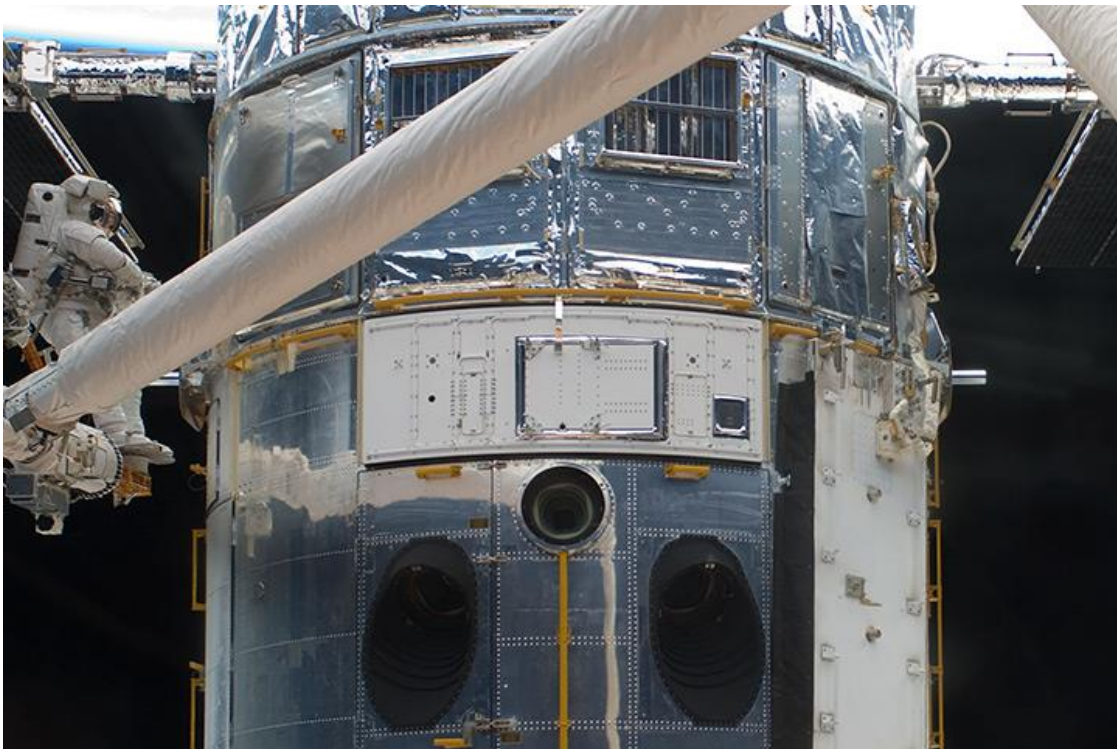
Слика 35: инсталација WFC3 и оквиру Сервисне мисије 4
